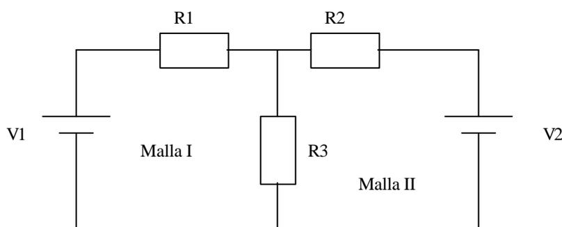
Medir el voltaje a través de cada resistencia prestando mucha atención a la polaridad de los terminales de cada elemento del circuito, y asegurarnos de esta forma, que la aguja se defleca en la dirección correcta
